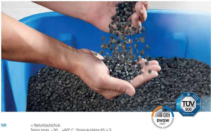
Temp.tmax.  $-30 \dots +60^{\circ}$  C, Shore-A-Härte  $65 \pm 5$
